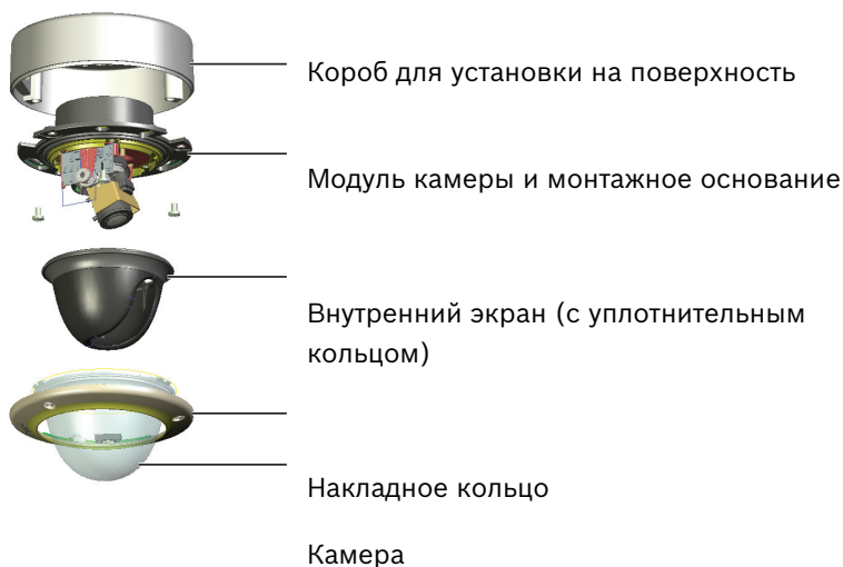
Рисунок 3.2 Установка на поверхность
