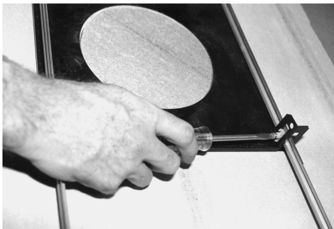
Рисунок 9.4: Затягивание крепежных винтов кронштейна
