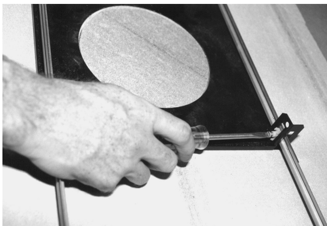
Рисунок 4.4 Затягивание крепежных винтов кронштейна
